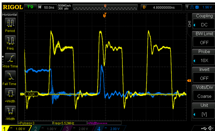
Obrázek 3.11: Zákmity na hodinovém signálu (žlutá) při špatné signálové integritě způsobující falešné aktivní hrany a chybové pulsy ve výstupních datech (modrá)
